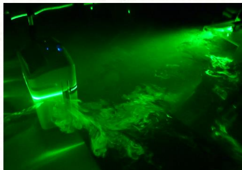
空気清浄機の流体画像解析 (PIV)
