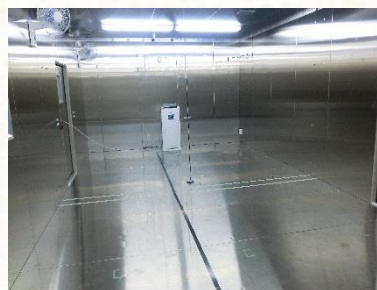
大形チャンバー内の空気清浄機試験
